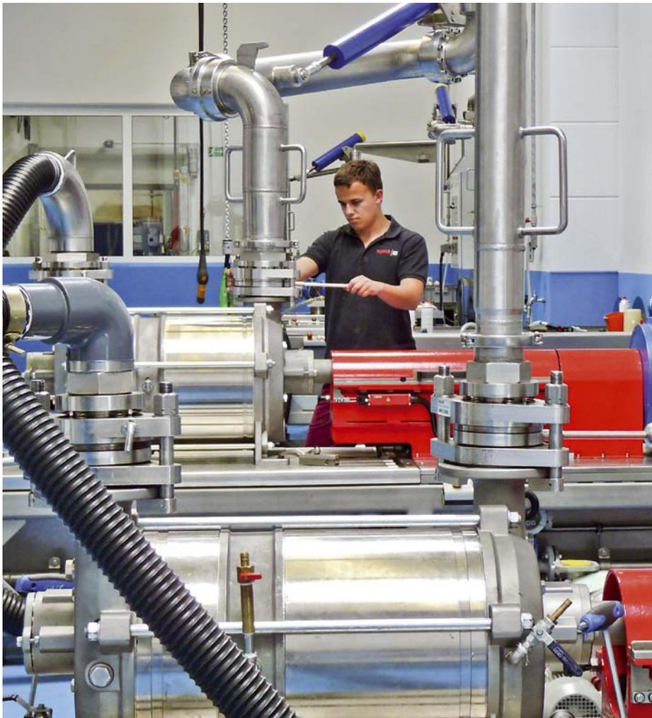
Bancs d'essai pour pompes à vide pilotés par ordinateur et complètement automatisés à l'usine de Speck à Roth. Mesure des performances hydrauliques, de la puissance requise et des vibrations. Essais jusqu'à une pression d'aspiration de 5 mbar et un débit volumétrique de 2000 m<sup>3</sup>/h.
