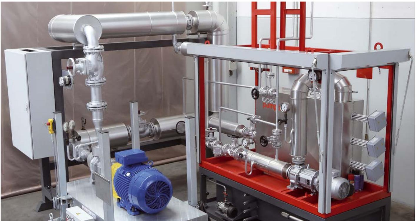
Bancs d'essai d'huile thermique avec système de surveillance de pompes à l'usine de Speck à Roth.
