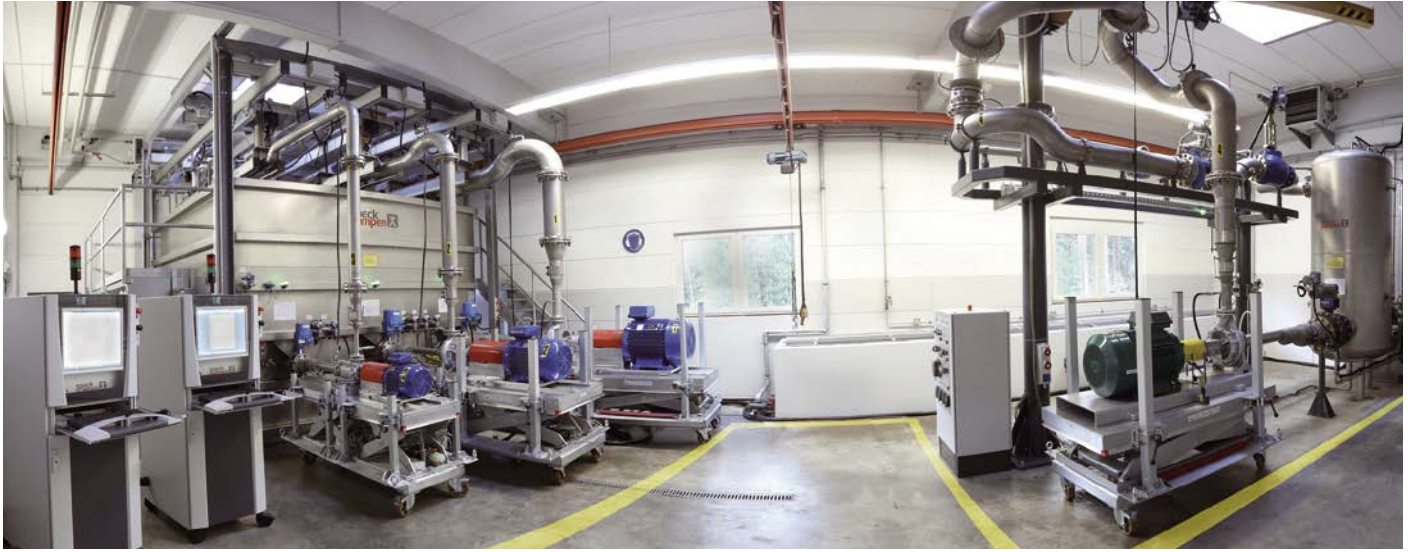
Computergesteuerte und vollautomatisierte Prüfstände im Werk von Speck in Roth. Messung von Hydraulik, Leistungsbedarf, Axialschub, Schwingungen und NPSH-Werten. Förderhöhen bis 400 m und Fördermengen bis 750 m 3 /h möglich.
