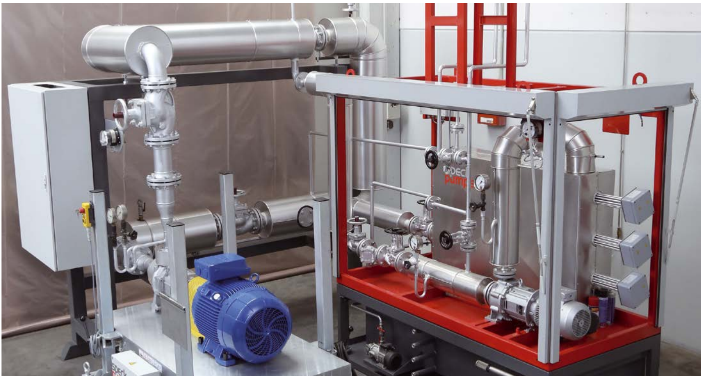
Thermalölprüfstand mit Pumpenüberwachungssystem im Werk von Speck in Roth. Erforschung der Auswirkungen hoher Temperaturen bis 350 °C auf die Lebensdauer von Pumpen.
